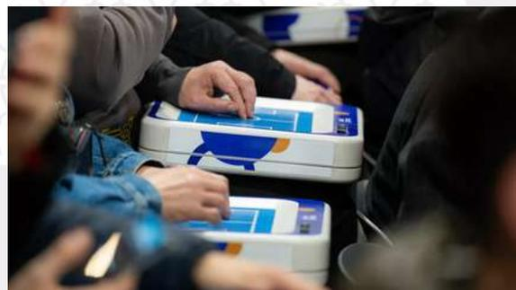
Ces tablettes innovantes permettent aux supporters déficients visuels de suivre les mouvements du ballon grâce à un curseur magnétique et des vibrations tactiles, offrant une immersion unique. Couplée à l'audiodescription fournie par la mairie de Toulouse, cette technologie révolutionne l'accès au sport et rapproche les fans de la passion du jeu.
